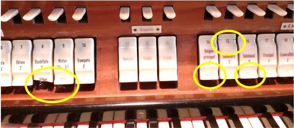
Beschädigte Registratur mit abgebrochenen Schaltern (April 2023)
